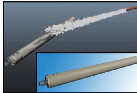
5. Laver le corps de tube et le sécher. Inspecter les canalisations et nettoyer si nécessaire. Si besoin, secouer du talc à l'intérieur de la nouvelle membrane avant de l'insérer sur le corps de tube.
