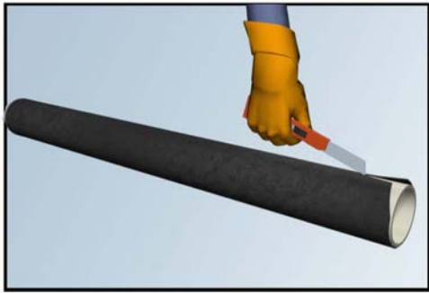
4. Couper l'ancienne membrane dans le sens de la longueur avec un cutter ou un couteau.
