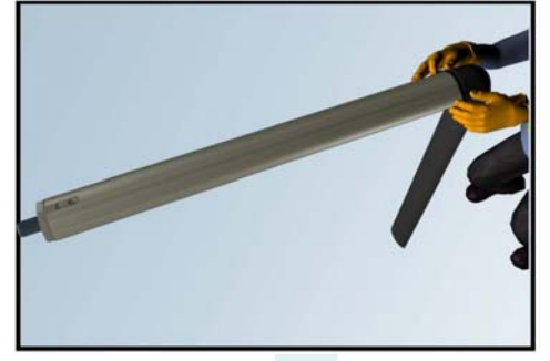
6. Glisser la nouvelle membrane sur le corps de tube. Attention : la bande non perforée doit être mise sur la partie supérieure, au-dessus des orifices d'arrivée d'air du corps de tube
